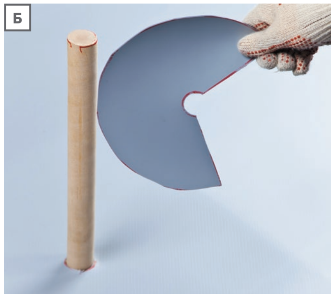
Б. Из него вырезается сектор размером около 1/3 круга.
